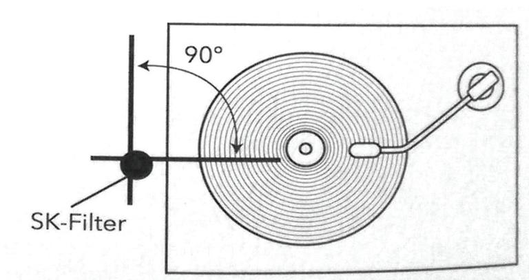
使用 L 型起子調整高低，刷子不能接觸到唱片表面，要保留 1mm~2mm 的空隙，SK-Filter 是除靜電，不是除灰塵的。
