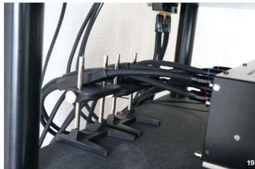
19. Jim在抑振處理上非常用心，在器材後面皆可見到他透過Furutech NCF Booster架線器將線材架起，這有利避開不必要的振動干擾。
