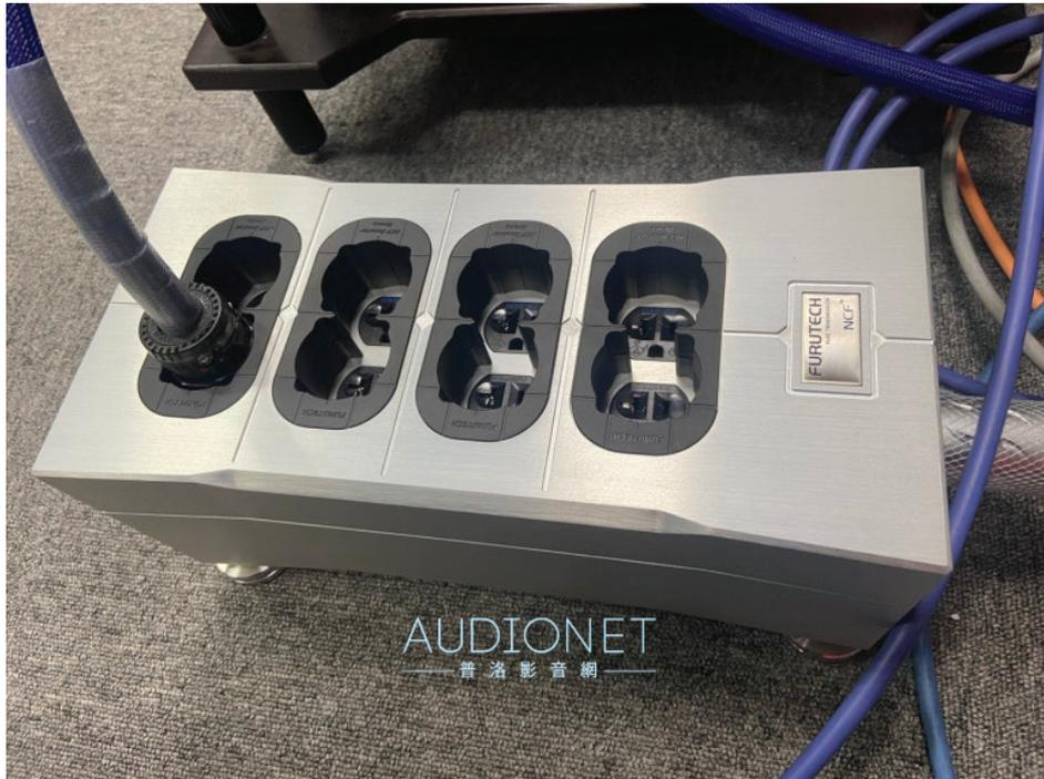
Furutech這幾年也將自家的NCF材質玩得爐火純青，不僅用NCF製作各種端子和調聲小道具，過去所推出的NCF電源產品不勝枚舉，其中也不乏多款電源排插，但是做工與用料遠不及這次的NCF Power Vault來得頂級。它從外殼開始以航空級的厚鋁合金錠CNC切削製成，表面再採用髮絲紋陽極處理，不只造型潔白高雅，且重達11.5公斤，除了本身具備很強的剛性，也能阻擋環境中的EMI和RFI雜訊，往下看到機身底部的抑振腳錐也做得很用心，尖錐本體採用不導磁的不銹鋼打造，可以防止外部振動傳入排插產生音染，底部還能加上橡膠墊片微調高度，讓排插站得更穩，完美貼合地面。
