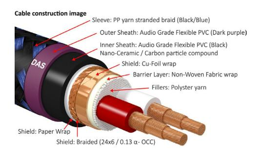
這是原廠擺在官網上 DAS-4.1 的結構示意圖,我們從裡面看起。這 DAS-4.1 採平衡式結構,內有兩股線芯。但請看,這每一股線芯的絞繞方式還有學問。這兩股線的導體線芯分為三層,最內層為 59 芯的 Alpha-OCC 導體,線芯一律往右旋;中層為 29 芯的 Alpha-DUCC 導體,線芯則往左旋;外層是 36 芯的 Alpha-DUCC 導體,再往右旋。每根線芯的線徑都是 0.13mm,導體雖然都是 7N 純度的銅線,且都經過 Furutech 引以為傲的 Alpha Process 的超低溫雨消磁處理,但一來分三層各不相同的絞繞方向,二來不同層的銅導體製程不同。最內層的導體是 OCC 單結晶銅,中層與外層的 DUCC (Dia Ultra Crystallized Copper)則是三菱材料公司所生產的長結晶銅。Furutech 在導體選用上,其目標顯而易見一選用結晶邊界最少,甚至理論上無結晶邊界的導體,力求傳遞更順暢,訊號損失最小。
