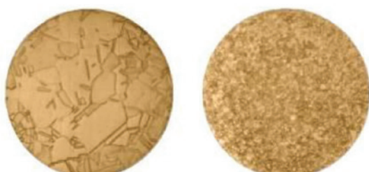
D.U.C.C. と一般的なOFCの金属組織の比較 Comparison of microstructures of D.U.C.C and typical oxygen free copper conductors
