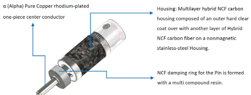
Furutech的線身阻尼環，共有4層，使用NCF與碳纖維、無磁不鏽鋼、航鈦鋁合金等材質所製成，內有固定線材之結構消除機械震動。上面有一個箭頭為方向性，需指向喇叭。
