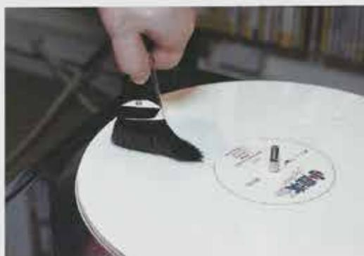
這款工具不但外型似十足化妝掃，就連名字也令人聯想到護膚品，它用上大量極為纖細、柔軟的山羊毛及丙烯酸類導電纖維，能夠掃走微塵，不會對物件表面造成損傷，同時導走清潔對象身上的靜電。當然，要達至這個效果，需要正確的使用方法，掃塵時需要把最少一隻手指，放到SK-III那個鍍銻金屬套之上，因為導電纖維吸走靜電之後，會把電荷引導到這個金屬套身上，再藉著與人體接觸，將之引走。
