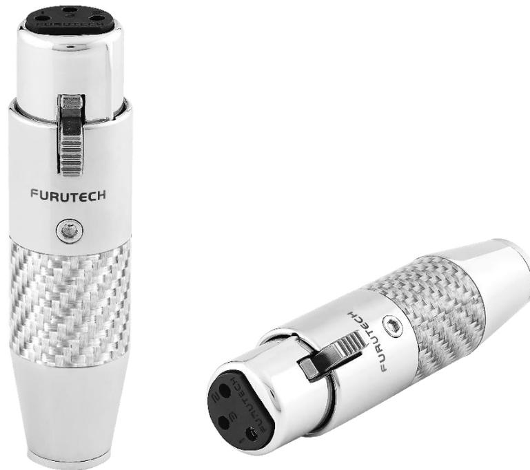
CF-601M 和 CF-602F 的銀光色外殼也不簡單，它結合了 NCF 聚合物、碳纖維層，及鍍銀 3K 碳纖維 NCF 層，經硬質透明塗層塗佈後，再覆蓋於非磁性不鏽鋼外殼上，兼具最佳性能與精緻外觀。CF-601M 和 CF-602F 尾端最大可容納 10mm 線徑的線材，內部接點則可容納 14 至 12AWG 之導線，固定方式為螺絲固鎖，或用焊接也可以。
